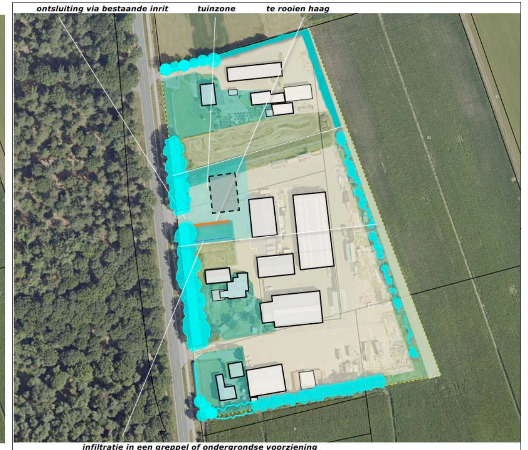
infiltratie in een greppel of ondergrondse voorziening
