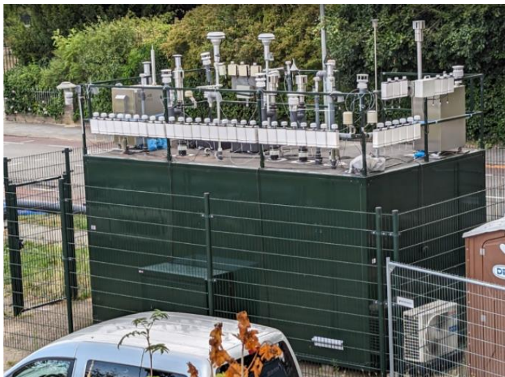
Figuur 2. Kalibratie sensoren meetstation Philipsweg Maastricht, zomer 2023
