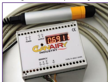
Figuur 6. Foto van een Canairry-sensor. Deze sensoren zijn ingezet in het project om geurstoffenpatronen te meten.
